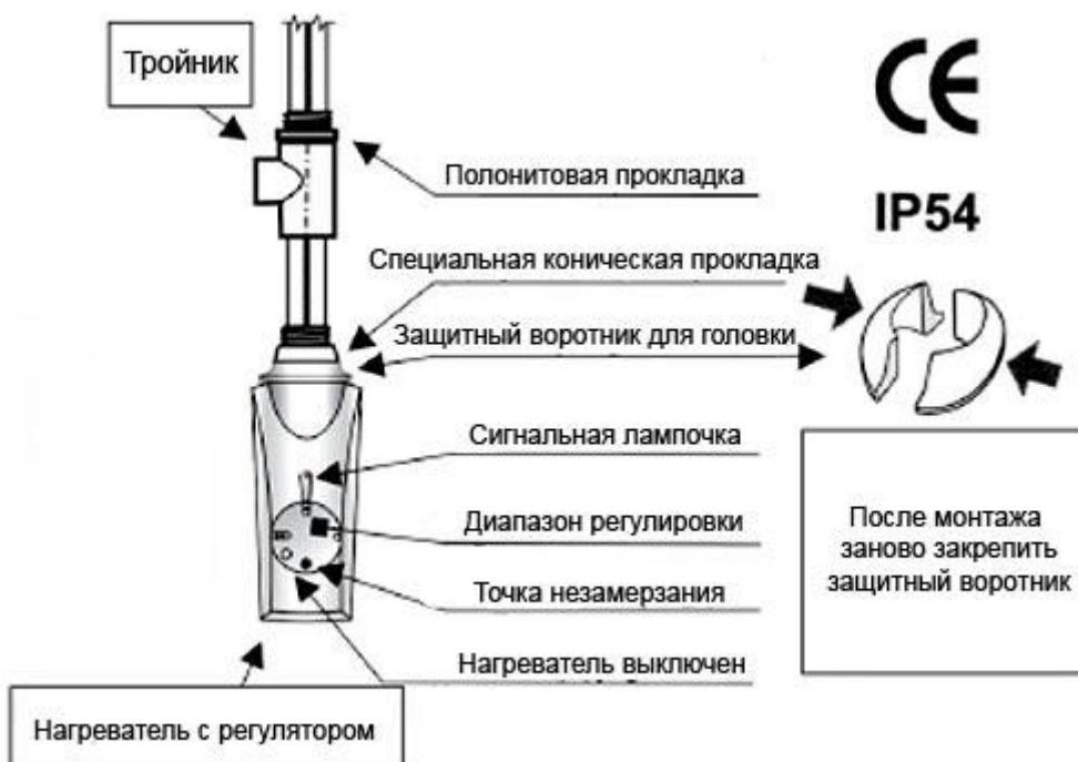
Установка нагревательного элемента осуществляется следующим образом:
