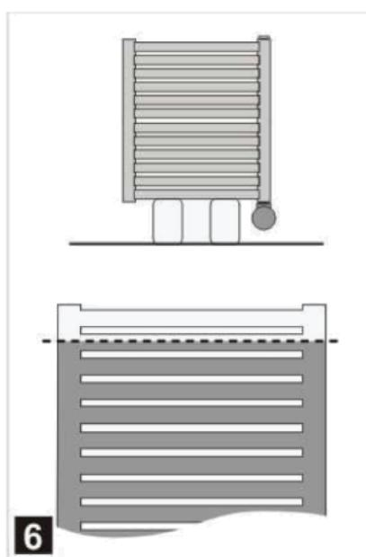
10. Пока радиатор нагрет, отлейте с него небольшое количество теплоносителя - до уровня половины последней трубы.
