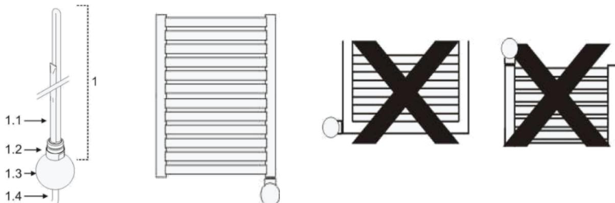
1.1. Нагревательный элемент    1.2. Головка    1.3. Панель управления    1.4. Кабель питания
